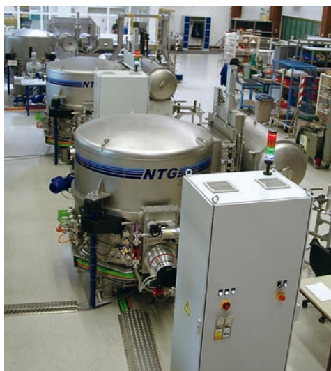
3 IBF 500 Anlagen mit Doppelschleusen
