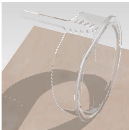
Lichtleiter für die Beleuchtung mit einer RGB-LED
