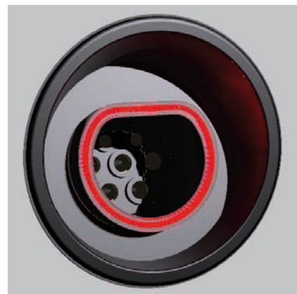
Photorealistische Simulation der beleuchteten Ladedose
