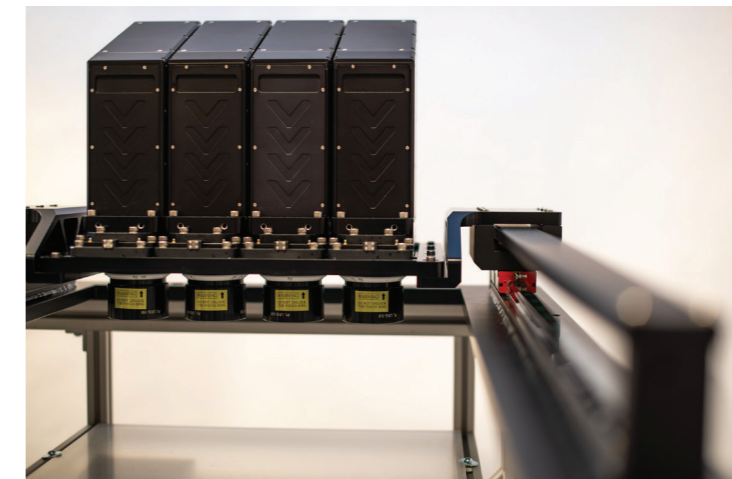
Visitech Projektionsmodule in einem Testaufbau für Dynamic Additive Manufacturing
