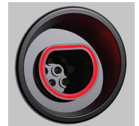
Photorealistische Simulation der beleuchteten Ladedose
