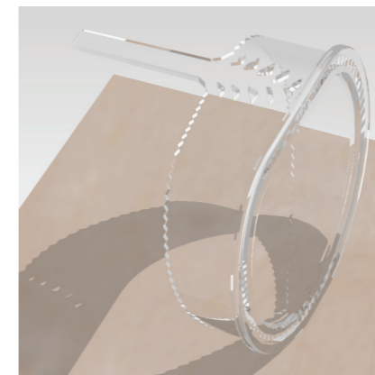
Lichtleiter für die Beleuchtung mit einer RGB-LED
